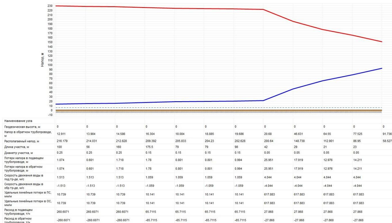
**Рисунок 2.32 – Пьезометрический график от источника теплоснабжения (котельной с. Бархатово) до самого удаленного потребителя в аварийной ситуации на сети**
