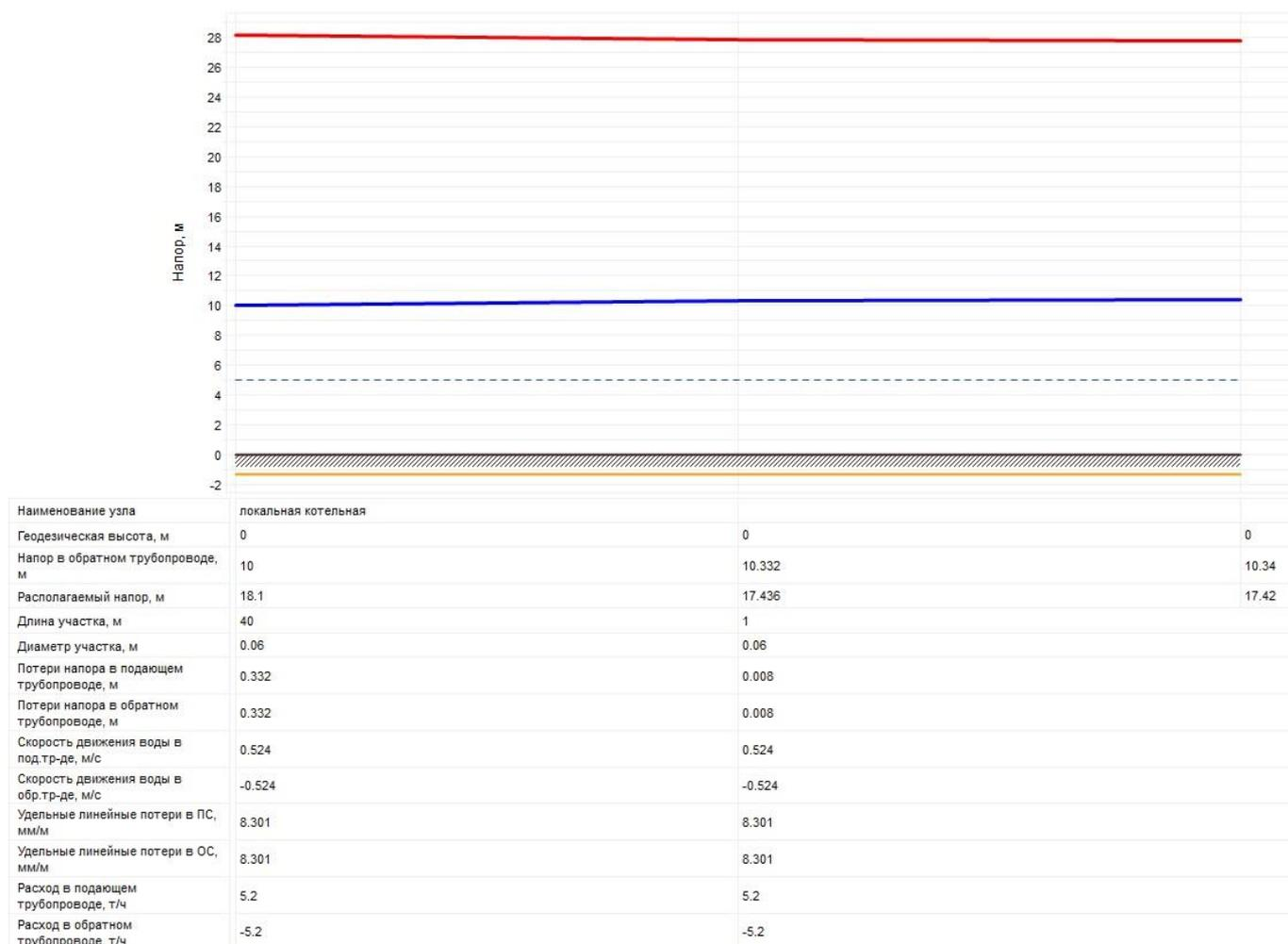
**Рисунок 2.34 – Пьезометрический график от источника теплоснабжения (локальной котельной д. Киндяково) до самого удаленного потребителя в аварийной ситуации на сети**
