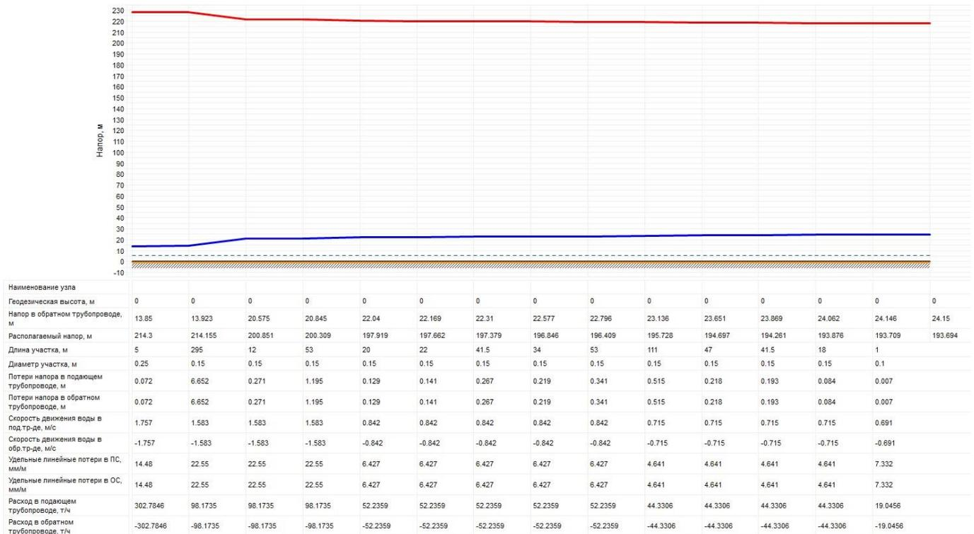
**Рисунок 2.35 – Пьезометрический график от источника теплоснабжения (котельной с. Бархатово) до самого удаленного потребителя в аварийной ситуации на источнике**
