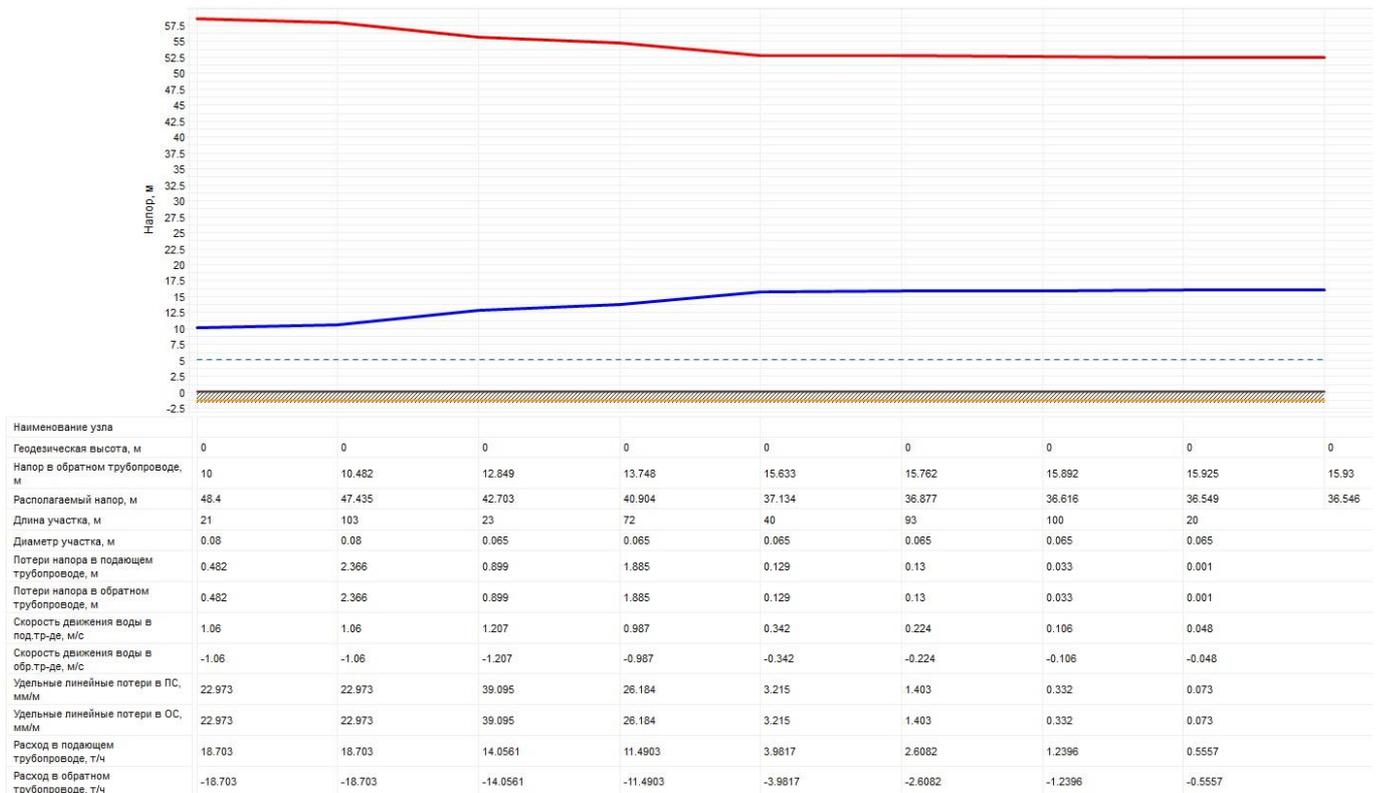
**Рисунок 2.36 – Пьезометрический график от источника теплоснабжения (котельной д. Киндяково) до самого удаленного потребителя в аварийной ситуации на источнике**
