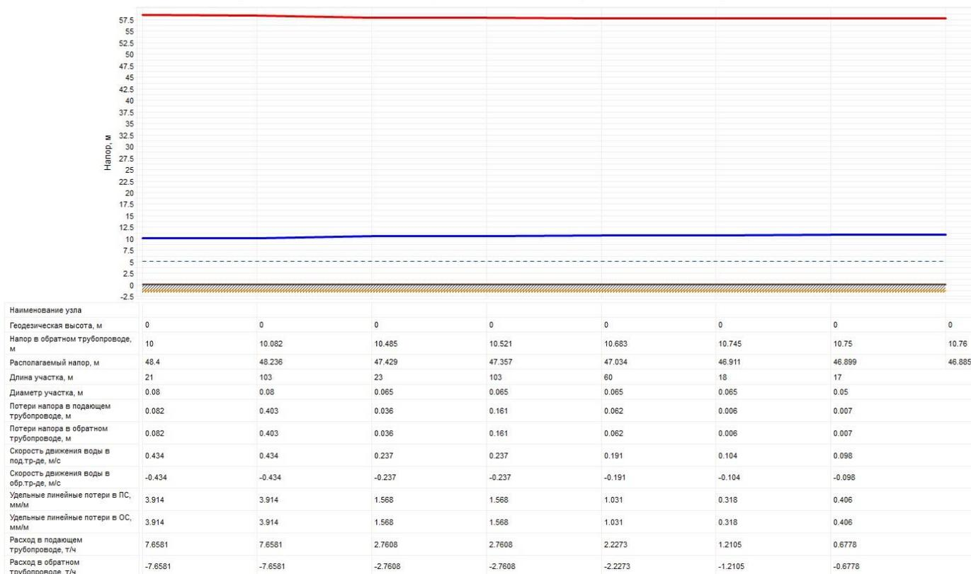
**Рисунок 2.33 – Пьезометрический график от источника теплоснабжения (котельной д. Киндяково) до самого удаленного потребителя в аварийной ситуации на сети**
