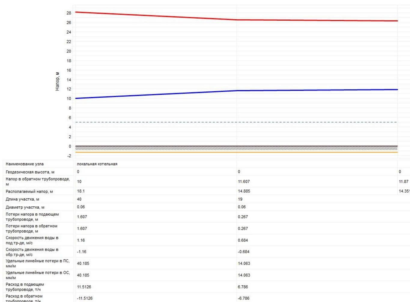
Рисунок 2.37 – Пьезометрический график от источника теплоснабжения (локальной котельной д. Киндяково) до самого удаленного потребителя в аварийной ситуации на источнике
