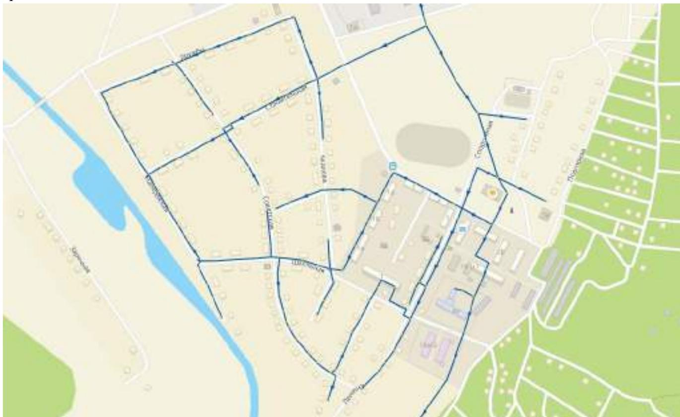
Рисунок 2.30 – Модель системы теплоснабжения котельной с. Бархатово
